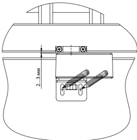
**🐜** *Сверлом диаметром 11 мм просверлите два
